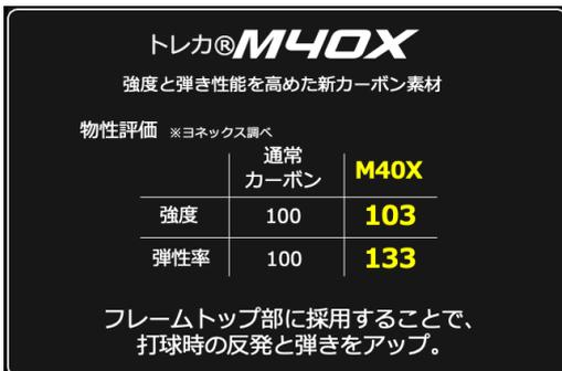
※トレカ®M40X は、東レ㈱が開発した、相反する「高強度と高弾性率」の両立を追求した次世代炭素繊維です。
