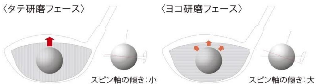
タテ研磨はヨコ研磨に比べ、タテ方向にボールがより動き易い。だからスピン軸が傾きにくく方向性が安定する。
