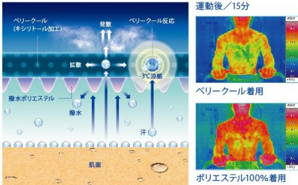
(左)ベリークールドライ機能図解 (右)サーモグラフィーを用いたベリークールの比較実験
