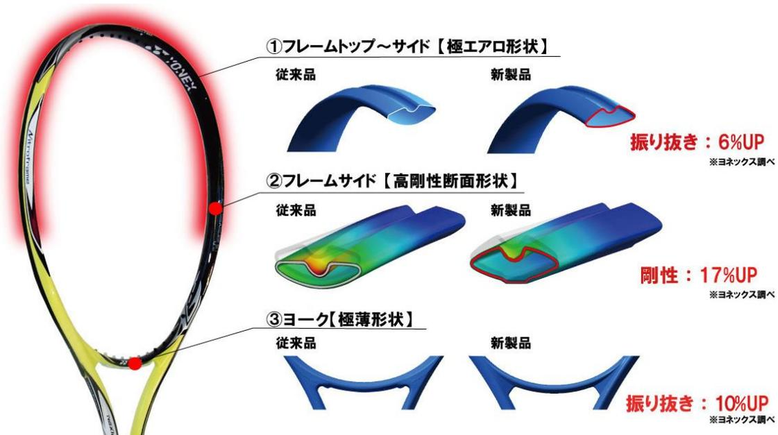
パワーと振り抜きの両方を追求した新フレーム形状「ナイトロフレーム」は、フレームトップからサイドにかけてエアロ形状を採用し、振り抜き性能をアップ(①)。フレームサイドは変形の小さい高剛性断面形状で打球時のパワーを向上(②)。フレーム下部は正面厚を薄くすることで、さらに振り抜き性能を高めます(③)。
