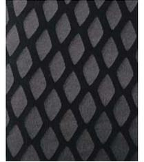
細かいひし形状の樹脂を熱加工し、強着圧を施すヨネックス独自の「スタビリティラバー」。縫製ではなく樹脂を熱加工することで、スタビリティラバーの加工位置・大きさ等を細かく調整。筋肉に沿って効果的に配置させることが可能となる。
